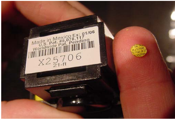
III. 4 : Gauche : les plaquettes d'identification (confettis) permettent de remonter jusqu'à la cartouche et au lieu du tir. Droite : câble présenté sans son isolant, cœur acier avec couche de cuivre.
